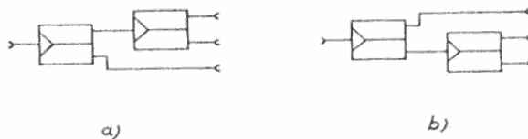
Obr. 6 — Příklad dvou variant čtyřcestné výhybky vytvořené kaskádním zobecněním
